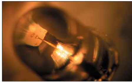
Рис. 13. Показан отрыв контактной нити от сварного соединения на площадке кристаллодержателя. Отчетливо видно место разрыва и оставшаяся на контактном пятке часть разваренной нити
