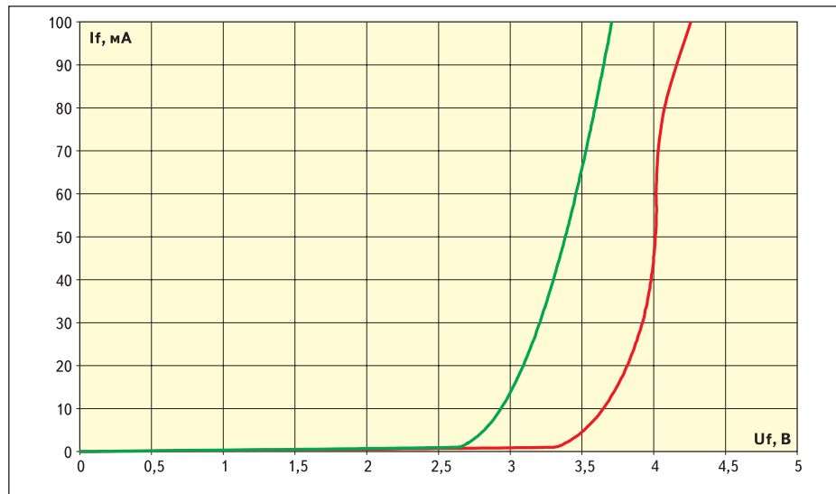
Рис. 16. ВАХ светодиода, омический контакт кристалла которого имеет ярко выраженный выпрямляющий эффект — красная кривая на графике, ВАХ исправного светодиода — зеленая
