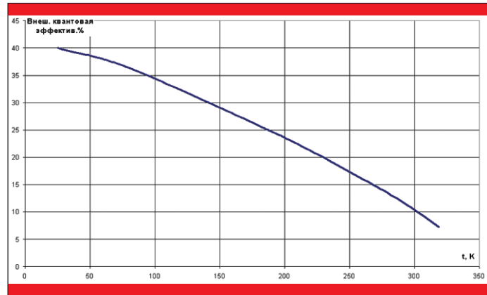
Рис. 2. Приближительная общая зависимость квантовой эффективности излучения гетероструктур материалов группы A³B⁵
