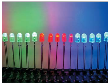
Рис. 11. Светодиоды фирмы «COTCO» типа LO5SMQ __-BOG с овальной оптикой 110×50 град
