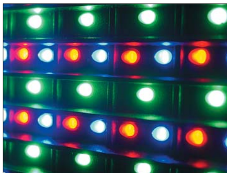
Рис. 10. Фрагмент полноцветного кластерного экрана. Пиксели собраны из светодиодов основных цветов
