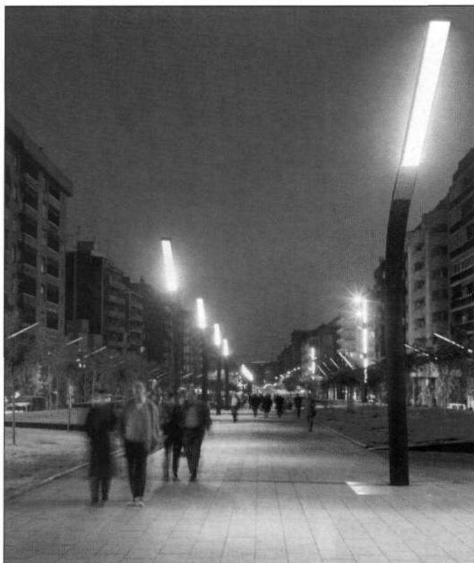
Рис. 11. Осветительные устройства с клиновидными световодами фирмы Socelec на улицах Барселоны
